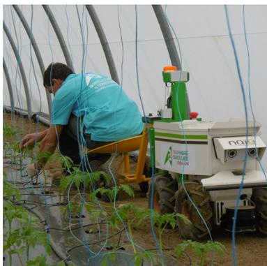
Un robot pour faciliter le palissage des tomates.
