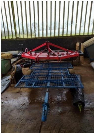
Remorque pour ramassage des poireaux servant également, une fois de retour au bâtiment, pour l'épluchage et le lavage. Le système évite plusieurs manipulations du produit.
