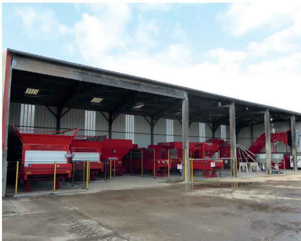
*Photo 6.5 : Cuisine avec tables et stockeurs Jeanfil et suppression d'un poteau pour accéder plus facilement aux stockeurs (ensilage en vrac)*
