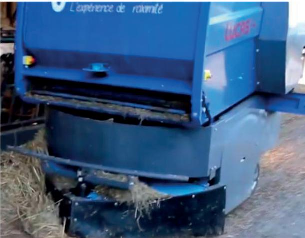
Photo 14.10 : Capteurs de détection d'obstacles
