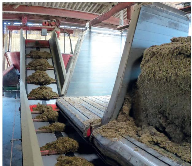
Photo 6.8 : Convoyeur disposé à l'arrière des tables Trioliet pour acheminer le fourrage vers la mélangeuse fixe
