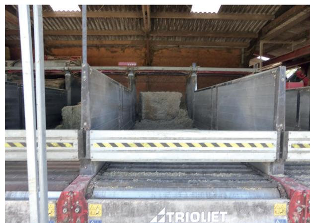
Photo 5.5 : Tables jointives de la marque Trioliet pour une plus grande compacité
