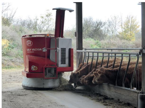
Photo 7.8 : Les automates sur roues adaptés notamment quand les bâtiments à desservir sont séparés les uns des autres
