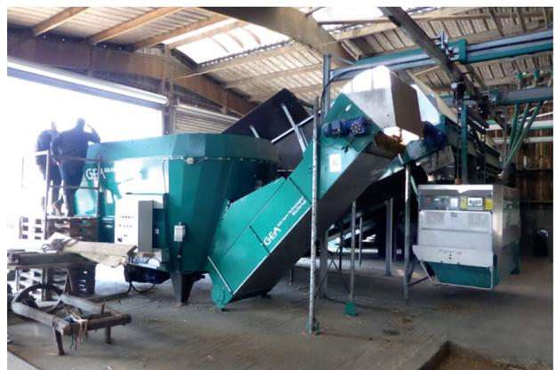
Photo 6.9 : L'automate passe et se charge directement sous les stockeurs et sous un convoyeur chargé d'apporter le foin
