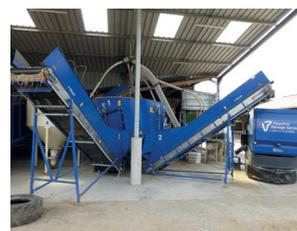
Photo 5.13 : Mélangeuse fixe Delaval équipée d'une double sortie par convoyeur
