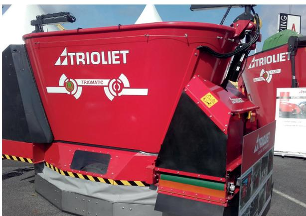
Photo 10.1 : Automate Trioliet sur roue avec alimentation électrique secteur sur rail
