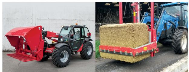
Photo 5.2 : Approvisionnement des fourrages grossiers : à gauche Godet à mâchoires tranchantes, à droite Dessil'cube fixé sur le chargeur du tracteur
