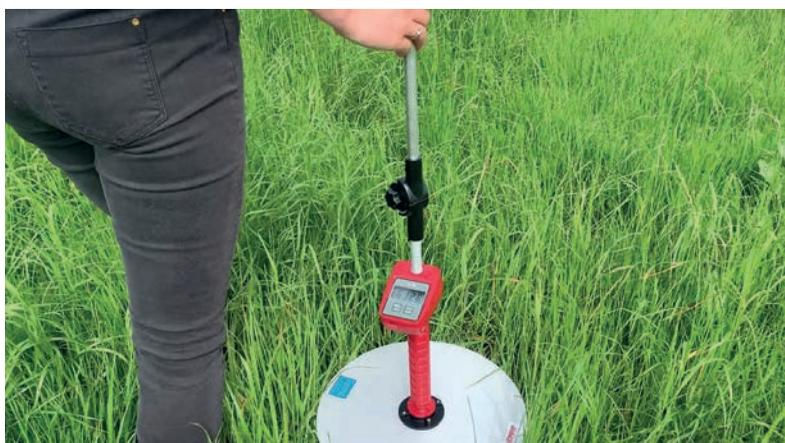
Les herbomètres électroniques sont d'une aide précieuse pour piloter finement le pâturage. Trop peu d'éleveurs sont équipés.
