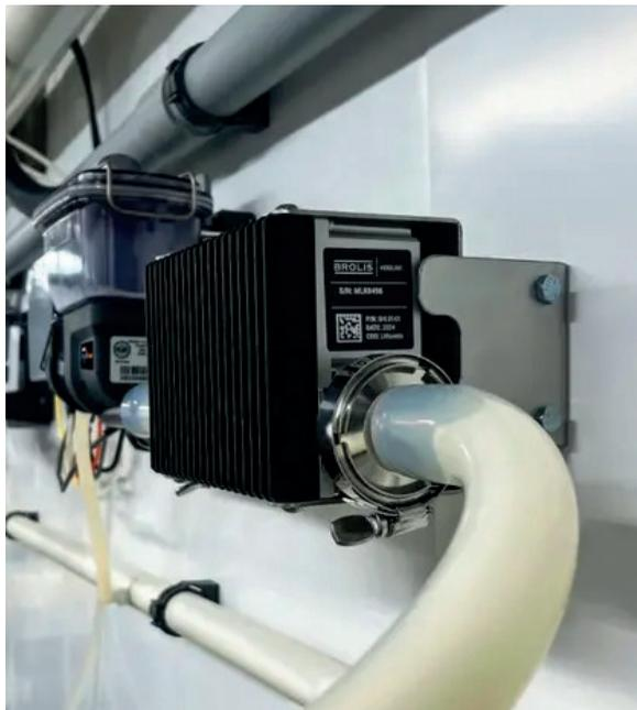
Les analyseurs de lait mesurent la conductivité, la température, voire parfois la composition et le niveau de cellules somatiques dans le lait. Ces dispositifs sont souvent intégrés dans ou associés à des robots de traite ou à des compteurs à lait.
