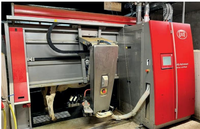
Les robots de traite sont l'une des technologies les plus présentes en élevage laitier (environ 30 % des élevages équipés). Ils permettent de lever l'astreinte quotidienne de la traite, mais nécessite un suivi attentif des données produites.
