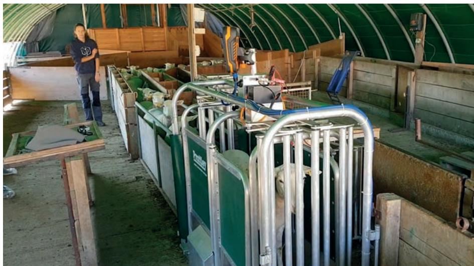
La cage de pesée et de tri automatique permet à un opérateur de peser 600 brebis par heure.
