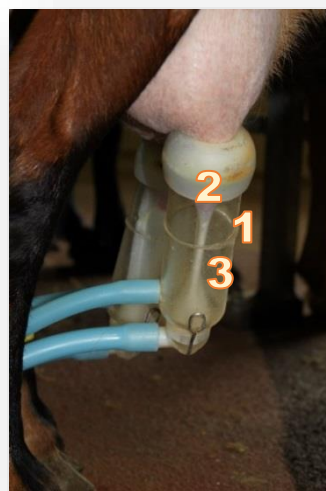
Photos 7 et 8 : Exemple d'étuis (1) transparents, laissant entrevoir les manchons trayeurs (2) en fonctionnement, ouverts à gauche (phase b, le lait s'écoule) et fermé à droite (phase d, le trayon est « massé »). On peut voir nettement la chambre de pulsation (3).
