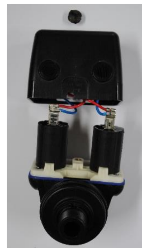
Photo 6 : Relais de pulsation électronique démonté permettant de visualiser les 2 électrovannes
