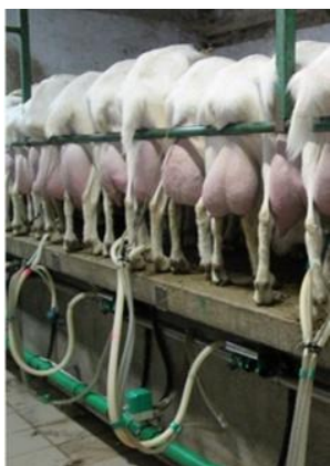
Photos 5 et 6 : Installations de traite, ligne basse à gauche : le lait s'écoule par gravité vers le lactoduc situé sous le quai, et ligne haute à droite : le lait remonte vers le lactoduc situé bien au-dessus du quai
