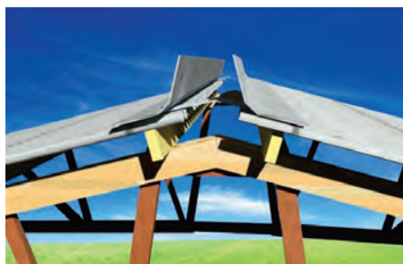
Photo 9 : la faîtière ouverte simple avec tôles pare-vent est le type d'ouverture le plus classique sur les bâtiments d'élevage de ruminants.
