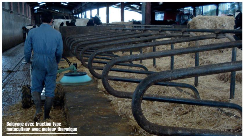
Balayage avec traction type motoculteur avec moteur thermique
