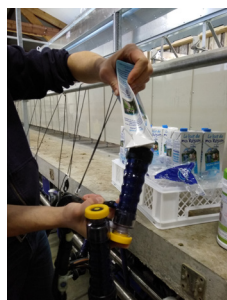
Récupération de la microflore présente dans la machine par passage de lait UHT dans celle-ci
