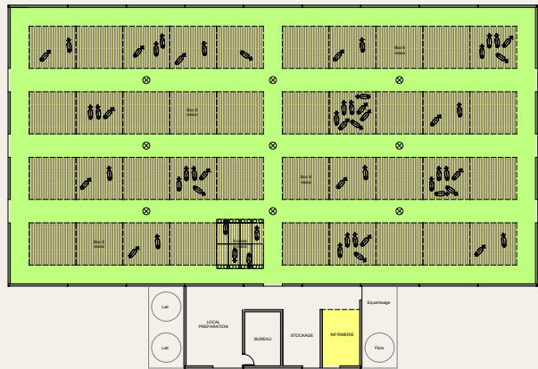
FIGURE 14 : VUE EN PLAN D'UN BÂTIMENT EN « DUR » DE VEAUX DE BOUCHERIE EN CAILLEBOTIS
