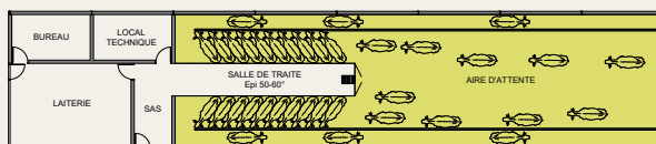
FIGURE 61 : VUE EN PLAN D'UN SYSTÈME DE TRAITE EN ÉPI 50° EN VACHES LAITIÈRES AVEC DEUX COULOIRS DE RETOUR
