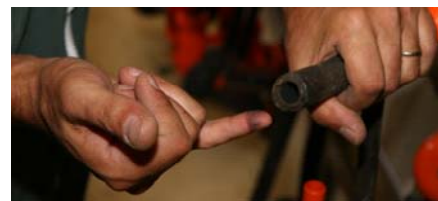
Exemple de tuyau à lait poreux (dépôt noir)
