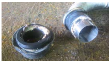
Joint de la MAT encrassé
