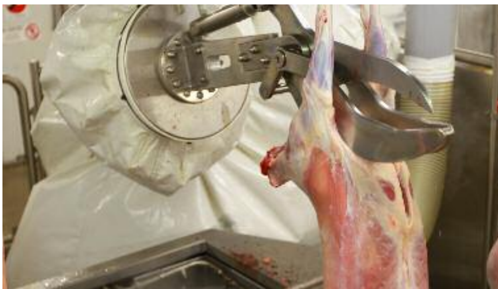
Robot découpant une poitrine d'agneau
