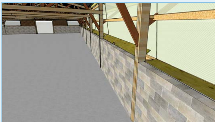
Figure 20: Ventilation bandeau décalé avec volets réglables (fermé et 45°) - solution initiale
