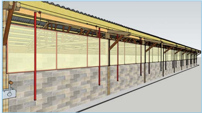
Figure 23 : Ventilation guillotine avec treuil (situation initiale)
