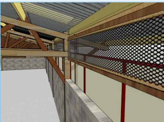
Figure 24 : Ventilation guillotine protégée (vue intérieure)
