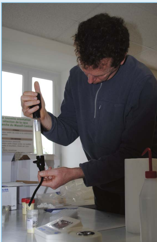
Le pèse colostrum, d'un coût d'environ 30 € HT, permet de discriminer les « bons » et les « mauvais » colostrums
