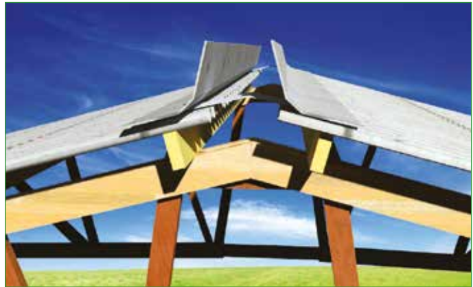
Figure 21 : Plan 3D de faîtière ouverte avec tôles pare-vent.
