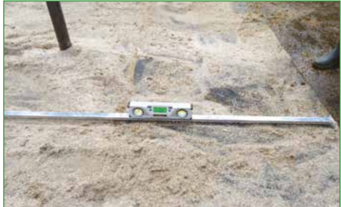
Photo 51 : Mesure de la pente des logettes avec tapis et farine de paille, en conduite lisier. Attention aux pentes excessives (> 4 %).
