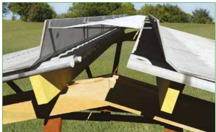
Figure 22 : Plan 3D de faîtière ouverte avec tôles pare-vent et pare-pluie.
