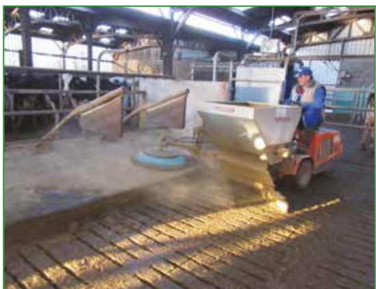
Photo 56 : Automoteur à triple fonction : balayage/nettoyage, apport de farine de paille et raclage des caillebotis sur 1,5 m pour un nettoyage immédiat de la zone la plus sale du couloir.
