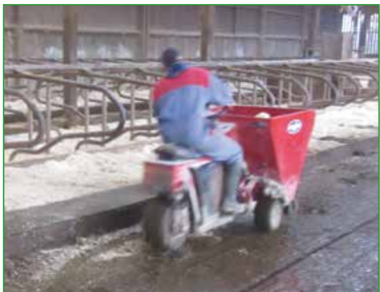
Photo 55 : Automoteur à double fonction : balayage/nettoyage et apport de litière (sciure). Pour bien contrôler l'entretien, cet éleveur préfère balayer en marche avant et apporter la litière en marche arrière.
