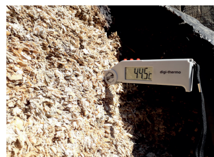
Photo 9 - Mesure de la température en bordure de silo
