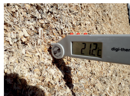
Photo 8 - Mesure de la température au cœur du silo
