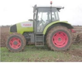
1 tracteur : 70 CV équipé d'un chargeur.
