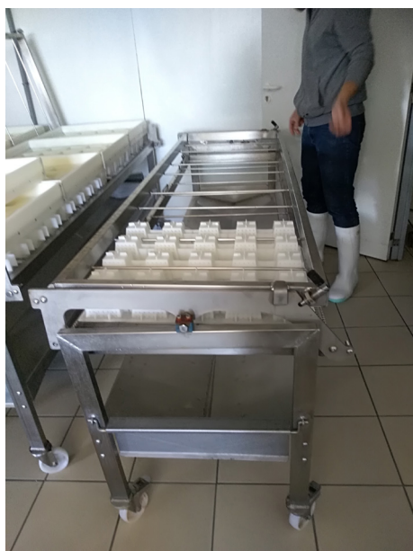
Photo 35 : Une table de retournement des multimoules en AOP Valencay
