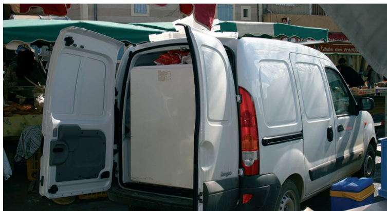
Photo 36 : Véhicule équipé d'un caisson frigorifique
