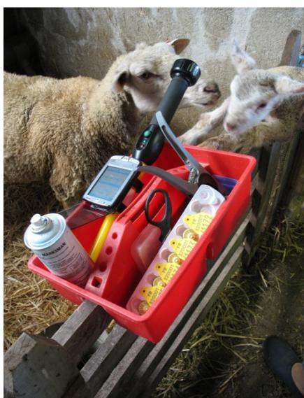
Lecteur mobile type bâton en connexion Bluetooth® avec PDA équipé d'un logiciel de gestion de troupeau. Socle porte PDA fixé sur le lecteur.
