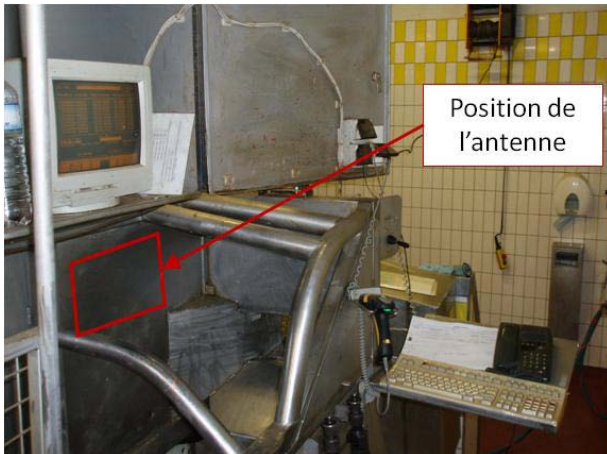
Sans RFID : lecture du code-barres de la boucle par un opérateur Avec RFID : lecture automatique
