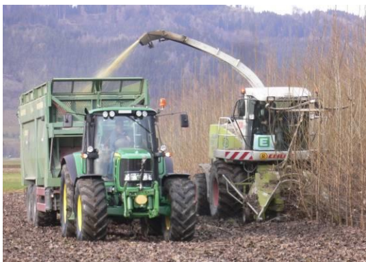
Abbildung 1: Feldhäcksler mit einem Spezialvorsatz (Verfahren 1)
