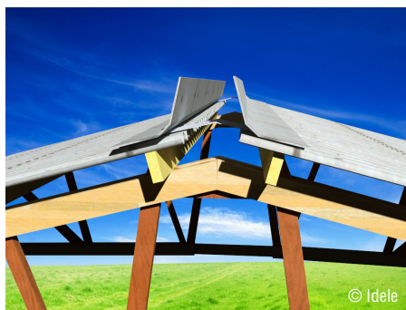
Photo 3 : Faîtière pare-vent avec pose en continue et protection des arbalétriers.
