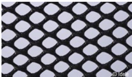
Photo 20 : Grille brise-vent très poreuse réduisant de 40 % les vitesses d'air.
