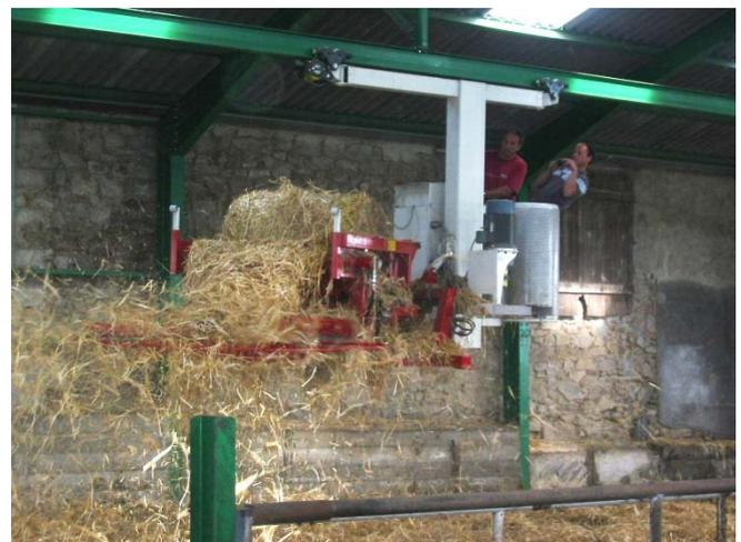
*Pailleuse suspendue avec poste de pilotage*
