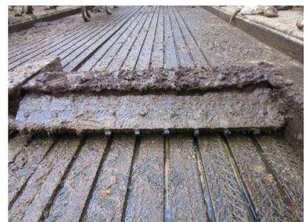
Un racleur à ergots sera nécessaire pour le nettoyage des rainures
