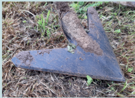
Outil à dents avec des socs type "patte d'oie" qui scalpent la prairie sous le plateau de tallage
