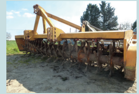
Le Dynadrive est un outil animé sans prise de force. Un premier rotor mis en mouvement par le déplacement du tracteur entraîne un second rotor avec une vitesse démultipliée
