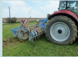
Déchaumeur à disques indépendants, équipé de 2 rangés de disques
