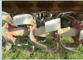
Outil animé type "Rotavator" : la disposition et la taille des pales doivent permettre de travailler sur toute la largeur de l'outil
