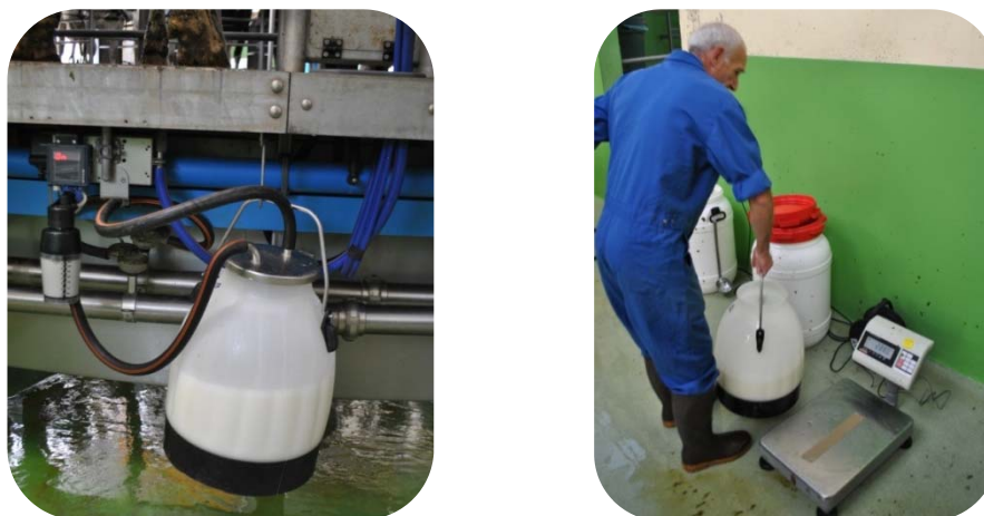
Figure 2 : vérification manuelle d'un compteur à lait
