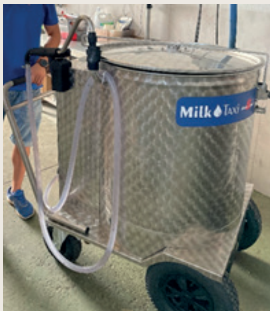
Taxi-lait pour distribuer le lait dans un des élevages les plus modernes (avec 5 000 JB et génisses engraisés/an). Eau chauffée à 40°C, pour taxi-lait.
