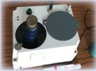
*Mesure de paramètres reflétant les conditions de massage et de traite avec un appareil spécifique*
