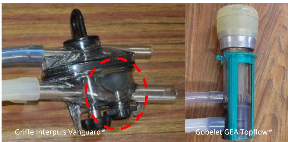
Photo 13 et 14 : Faisceaux trayeurs avec clapet de fermeture automatique sur le collecteur à gauche et sur le gobelet trayeur à droite
