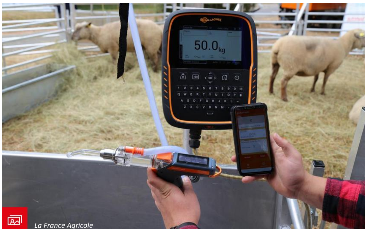
Figure 2 : Le pistolet drogueur automatique AUTOMED®
