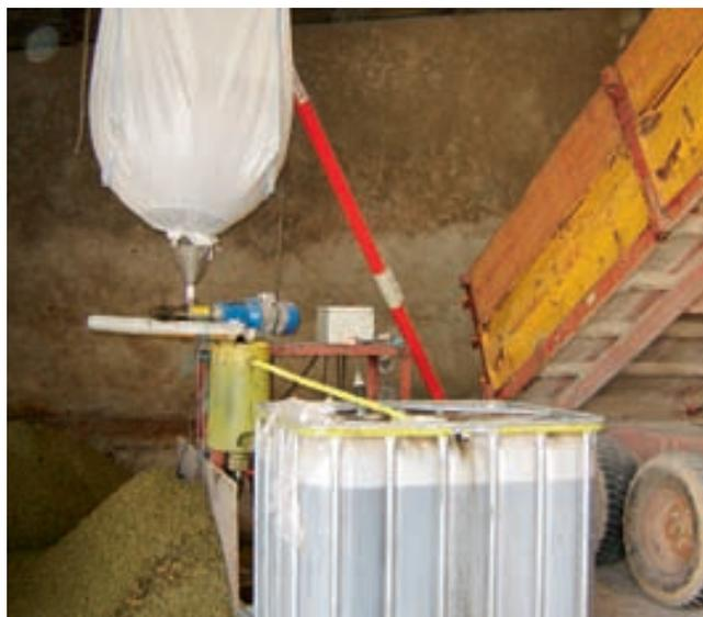
Le pressage d'une tonne de graines de colza permet d'obtenir en moyenne 300 litres d'huile filtrée et 650 kg de tourteaux gras.
