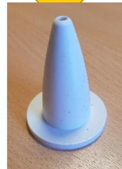
Trayon souple finalisé prêt à être utilisé sur mamelle artificielle
