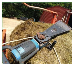
*Séparation d'une botte d'enrubannage avec une tronçonneuse à fourrage*
