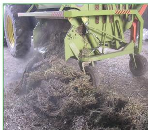
*Dérouleuse équipée d'un système de coupe (dérouleuse trancheuse)*
