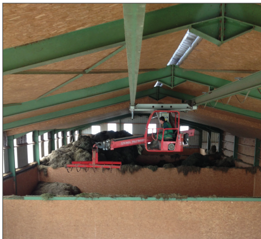
Figure 8 : Un séchoir de type vrac composé de 3 cellules rectangulaires
