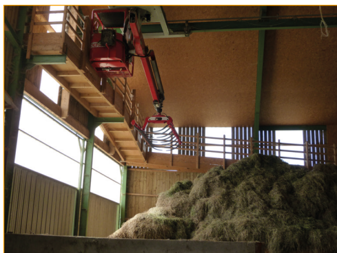
Un séchage en grange avec une griffe pour distribuer le foin ventilé.
