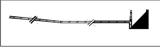
Le stockage des déjections (fumier et purin) se fait conjointement dans le même ouvrage. La séparation physique se produit lors de la vidange du liquide derrière la paroi d'égouttage.
