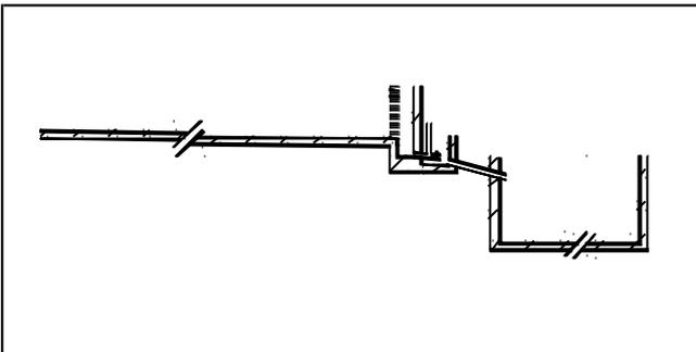
Les déjections sont acheminées vers la fosse universelle où se fait la séparation entre la phase liquide et la phase solide. La partie solide (fumier) reste en place dans la fosse universelle, la partie liquide est stockée séparément dans une fosse indépendante par écoulement gravitaire ou par pompage à partir du système d'égouttage.
