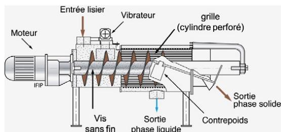
C'est le type de matériel le plus répandu et qui permet d'atteindre des niveaux de matière sèche élevés pour la phase solide, un système de contre-poids ou de ressort permettant de régler une contre-pression variable.
