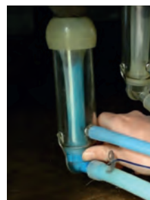
Simulation d'orifice calibré bouché : traite humide garantie (remontée du lait coloré en bleu)
