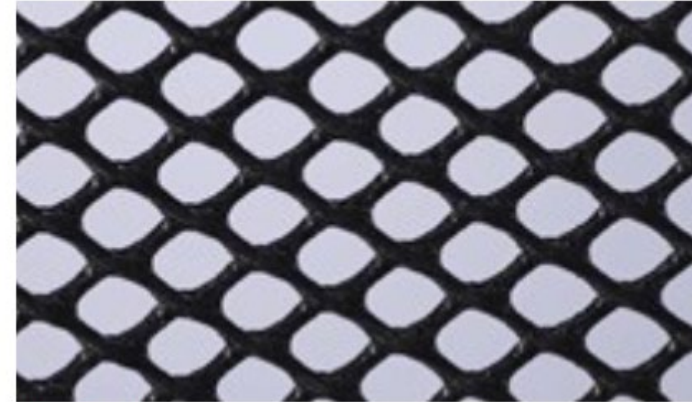
Photo 7 : Grille brise-vent très poreuse réduisant de 40 % les vitesses d'air.
