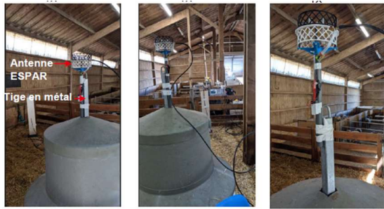
Test de l'antenne en condition d'élevage d'engraissement des agneaux
