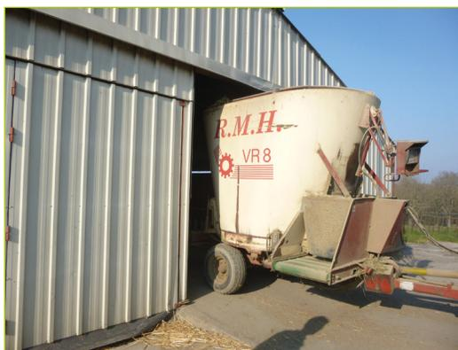
*Le bâtiment d'élevage doit permettre la circulation de la mélangeuse : largeur supérieure à 4,5 m et hauteur supérieure à 3-3,5 m pour le couloir.*
