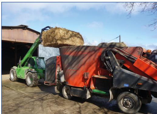
*Mélangeuse automotrice, lors d'une vérification de la précision du système de pesée avec une botte de paille préalablement pesée*
