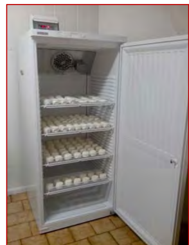
Photo 6 : armoire de séchage Source : G. Allut, CFB
