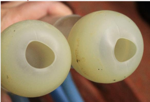
Le sifflement des faisceaux trayeurs révèle l'existence d'entrées d'air dues au glissement des manchons ou aux chutes des faisceaux. Le phénomène d'impact peut être alors fréquent même s'il est sans doute limité lorsque l'on emploie des griffes à ouverture-fermeture automatique (dans la mesure où celles-ci sont bien entretenues).
