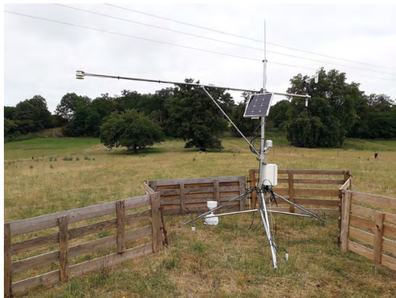
Pendant plus de 3 ans, cet albedomètre installé sur le site expérimental du Mourier a enregistré l'albédo journalier toutes les 10 mn.
