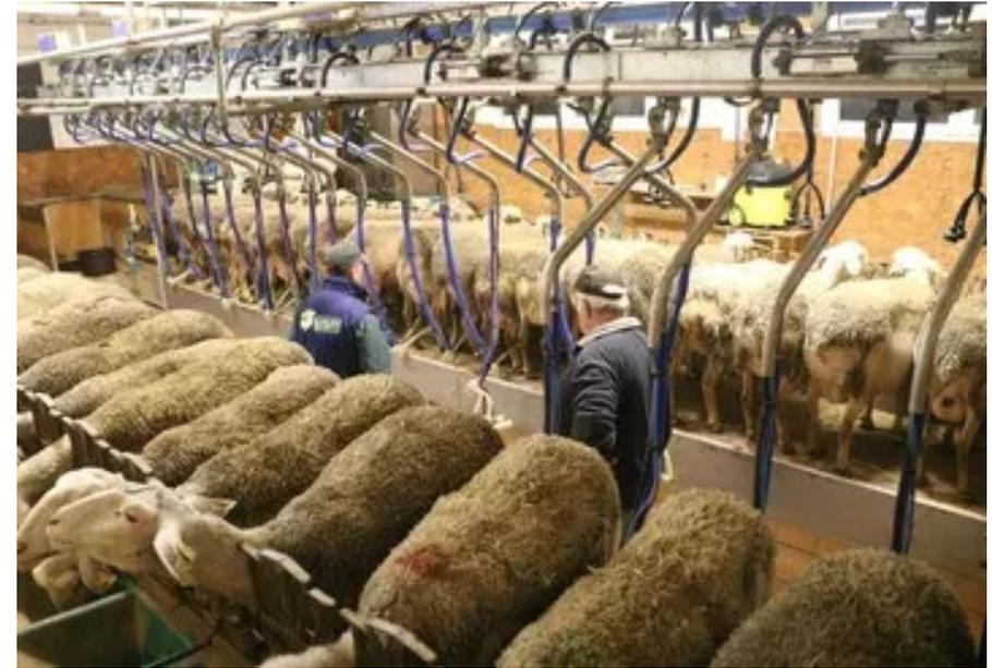
Déposes des faisceaux → système de temporisation (évolution vers débitmétrique)
