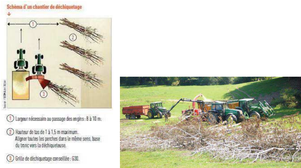
Figure 14 : Schéma d'un chantier de déchiquetage (CLIMAGROF - CIIRPO)
