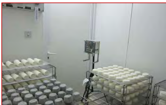
Photo 1 : prototype « sacha » développé par l'INRA, mesurant en continu la température, l'hygrométrie et la teneur en gaz à proximité des fromages lors des enquêtes en ferme
