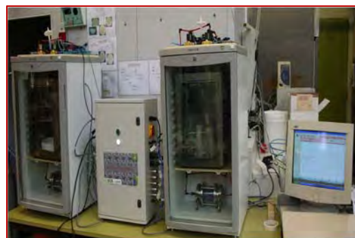
Photo 5 : dispositif expérimental à deux cellules d'affinage à l'INRA Grignon (unité GMPA) Source : D. Picque, INRA
