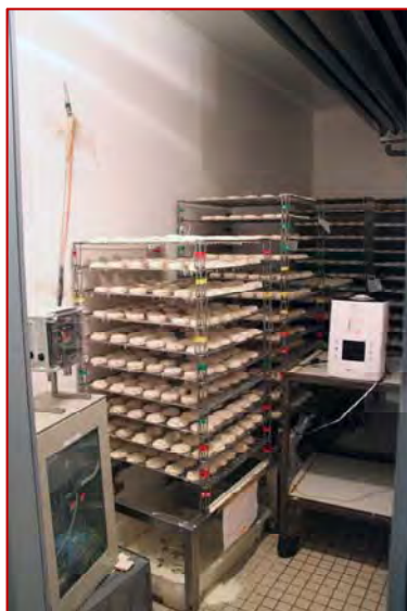
Photo 2 : humidificateur et dispositifs de mesure des paramètres d'ambiance dans un hâloir à la station caprine expérimentale EPLEFPA
