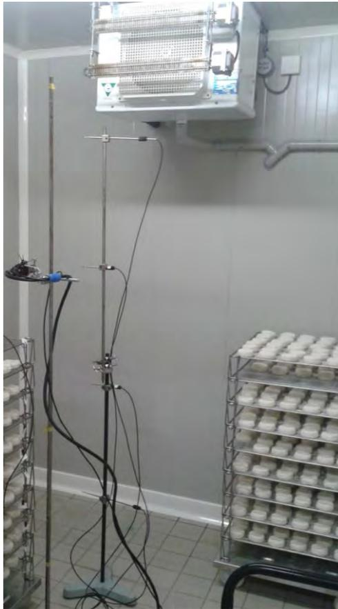
**Figure 1 : Dispositif expérimental utilisé pour cartographier l'aéroulque (vitesse, température et humidité de l'air) au sein des installations fromagères (séchoirs et hâloirs)**
