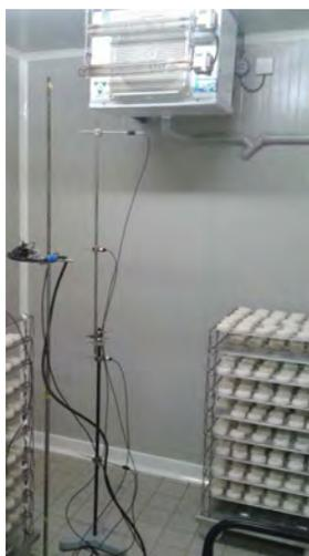
Photo 4 : mesures des conditions d'ambiance en différents plans d'un hâloir (photo P.-S. Mirade, INRA)
