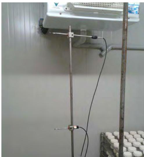
Photo 5(a) : sondes anémométriques de mesure des vitesses d'air
