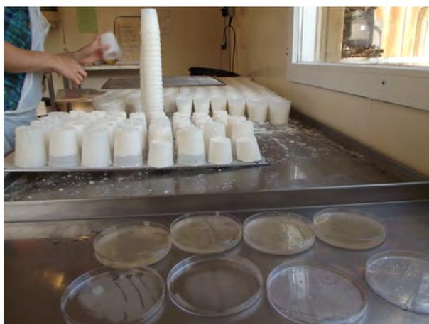
Photo 1 : prélèvement des microflores d'ambiance par sédimentation sur des boîtes de Pétri en salle de fabrication (G. Allut, Centre Fromager de Bourgogne, CRA Bourgogne)
