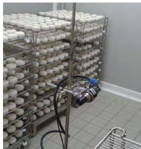
Photo 5(b) : hygromètre à miroir à point de rosée de mesure de l'humidité relative équipé de sa sonde de température Pt100
