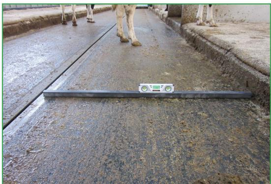
Photo 11 : Mesure de la pente transversale avec un niveau électronique posé sur une barre métallique
