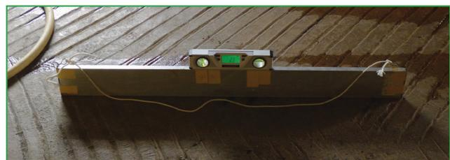
Photo 7 : Mesure de la pente avec un niveau électronique posé sur une barre métallique
