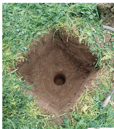
Prélèvements de sol pour mesure de densité apparente OCBO, 2024 et taux d'éléments grossiers.
