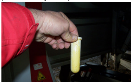
PHOTO 2 : Test de la couverture de la pulvérisation à l'aide d'une "tétine à veau"
