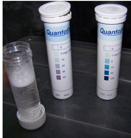
PHOTO 3 : Bandelettes test pour titrer le peroxyde d'hydrogène et l'acide peracétique
