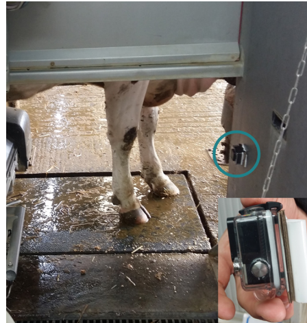
PHOTO 1 : Point d'attache de la caméra sur un Lely A4 et dispositif d'attache avec un carton et de l'adhésif double face
