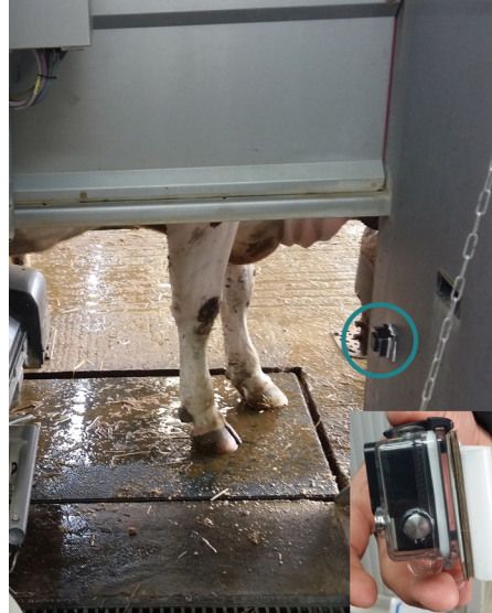
PHOTO 1 : Point d'attache de la caméra sur un Lely A4 et dispositif d'attache avec un carton et de l'adhésif double face
