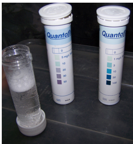
PHOTO 3 : Bandelettes test pour titrer le peroxyde d'hydrogène et l'acide peracétique
