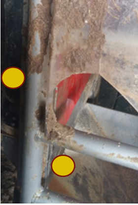
PHOTO 7 : Points de passage de la chiffonnette pour les prélèvements du DAC
