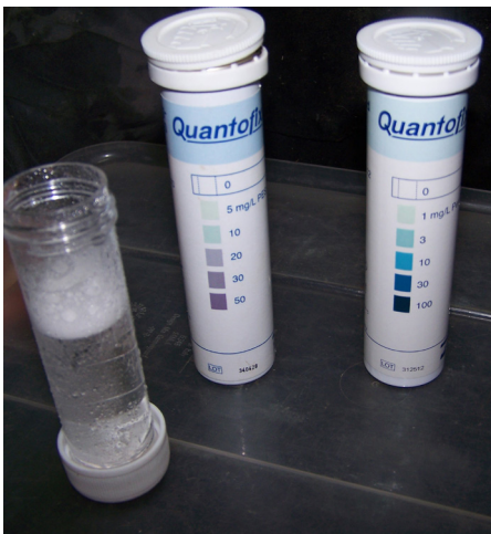
PHOTO 2 : Bandelettes test pour titrer le peroxyde d'hydrogène et l'acide peracétique
