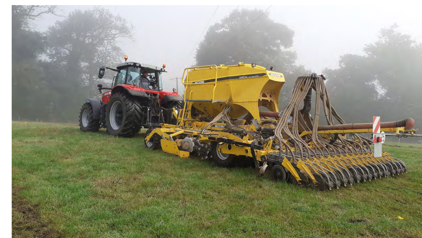
Semis Vredo : semoir en ligne avec disque
