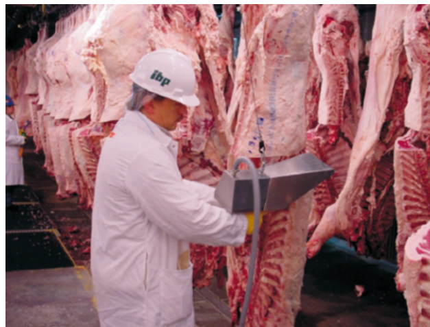
Figure n° 18: Le VBG 2000 est utilisé aux États-Unis pour la mesure de la surface, de l'épaisseur, du rendement et du persillé de l'entrecôte
