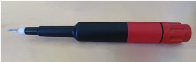
Figure n° 3 : Électrode pH combinée à pointe de verre et électrolyte polymérisé sous forme solide
