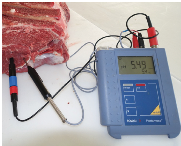
Figure n° 2: pH-mètre avec électrode de verre (à gauche) et sonde de température (à droite) séparées
