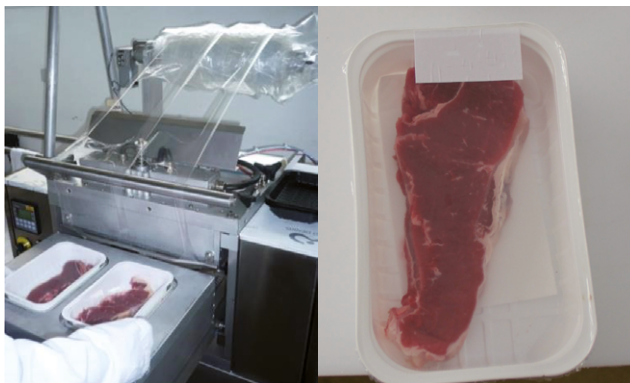
Figure n° 4 : Le conditionnement sous atmosphère modifiée consiste en l'injection de gaz dans la barquette
