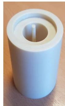
Moules et contre-moules dessinés et imprimés en 3D en fonction de cotes réelles
