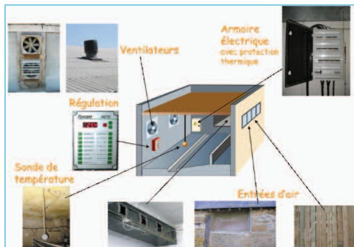
Les divers éléments d'une installation de ventilation dynamique
